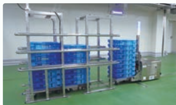
コンテナを搬送するAGV（自動搬送機）
