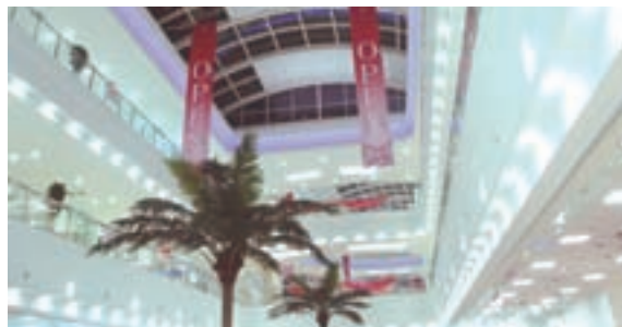
▲天窓に熱遮断ガラスを使用した開放感あるセントラルコート
